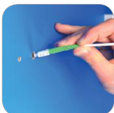
złącze SC2/APC - montaż w 8mm
