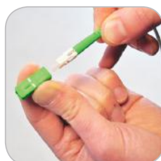
montaż obudowy SC/APC na złączu SC2
