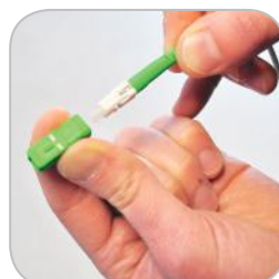
montaż obudowy SC/APC na złączu SC2
