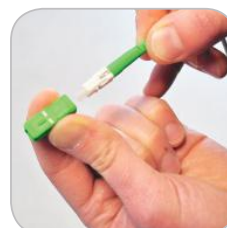
montaż obudowy SC/APC na złączu SC2
